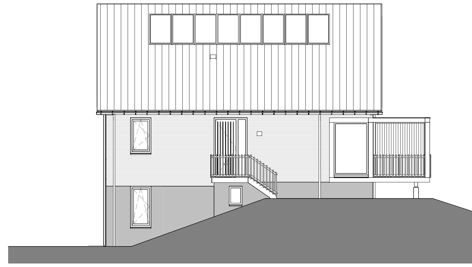
linker zijgevel Verloop talud is indicatief, de gemeente maakt het terrein woontijp. Verloop kan nog wijzigen. schaal 1 : 100
